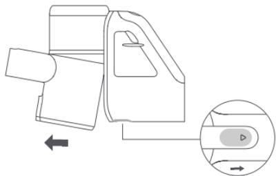
2. Rode o conjunto do ciclone na direção mostrada na figura. Montagem do ciclone
