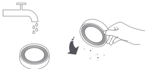
4. Para secar completamente o filtro, mantenha-o em um local ventilado ou fresco por pelo menos 24 horas após a limpeza.
