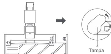
3. Separe a tampa da extremidade do rolo e remova qualquer cabelo enrolado no rolo e da tampa.
