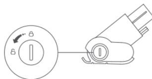
2. Após remover a trava, remova o rolo do encaixe da cama.
