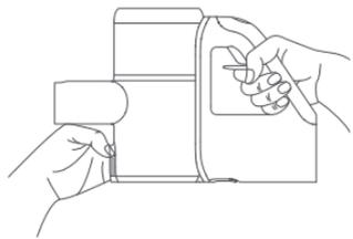
3. Enquanto empurra o interruptor próximo ao compartimento de pó na direção da seta, puxe o compartimento para fora do vácuo para limpá-lo com água.
