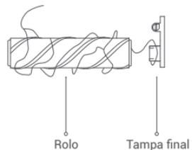
4. Após a limpeza, instale a tampa traseira novamente no rolo.
