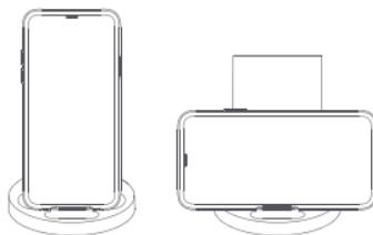
4. Quando o indicador LED estiver a piscar em verde, o suporte de carregamento sem fios encontrou um erro e as medidas de proteção foram ativadas. Verifique se algum objeto metálico foi colocado no suporte de carregamento. Nesse caso, remova-o e verifique se o suporte de carregamento continua a carregar. Se o problema persistir, entre em contacto com o departamento de serviço pós-venda.
