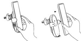
5. Quando o carregador de carro sem fio Mi 20W não puder ser fixado a uma abertura de ventilação com seu grampo, o suporte adesivo fornecido poderá ser usado para fixá-lo em uma superfície plana.
