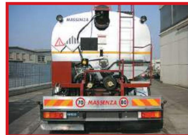
**Design especial** para betume de elevada viscosidade, com um circuito de grande fluxo livre, aquecimento a óleo quente da tubagem, válvulas, barra de pulverização, filtro etc.
